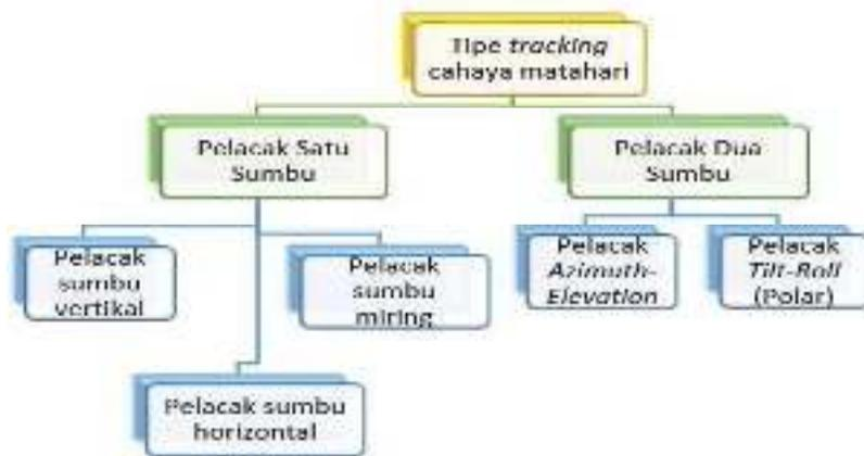
Gambar 2.10 : Tipe *solartracking* berdasarkan sumbu putaran
