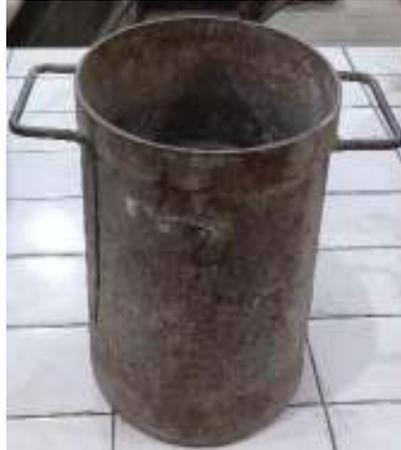
Gambar 2.4 Wadah mould yang digunakan dalam takaran volume
