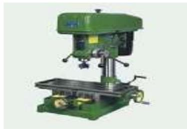
Gambar 3.13. Mesin *Milling*
